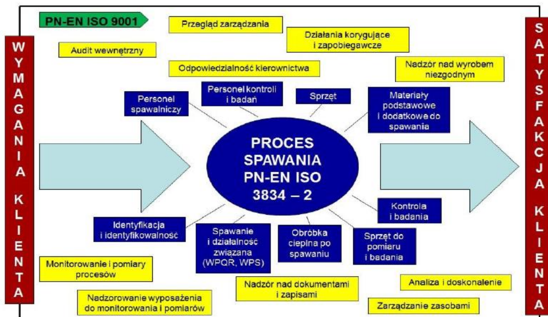
Rys.1: Schemat realizacji procesu wytwarzania wyrobu spawanego zgodnie z wymaganiami zintegrowanego systemu zarządzania jakością wg normy PN-EN ISO 9001 i PN-EN ISO 3834-2
