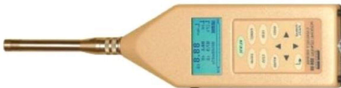
Rys. 16. SON-50 – całkujący miernik poziomu dźwięku 1 klasy
