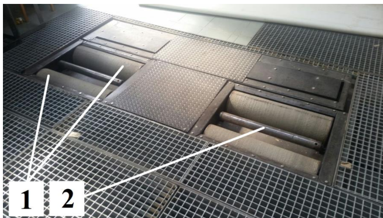
Rys. 5. urządzenie rolkowe do oceny skuteczności działania hamulców: 1 – rolki napędzające, 2 – wałek kontrolna zablokowania koła
