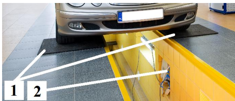
Rys. 6. Urządzenie do wymuszania szarpnięć kołami jezdnych pojazdów: 1 – płyty najazdowe, 2 – silnik elektryczny i pompa hydrauliczna
