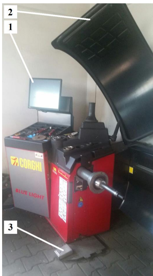
Rys. 2. Wyważarka kół: 1 – dotykowy ekran sterowania, 2 – osłona koła, 3 – płyta naciskowa uruchamiająca napęd
