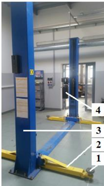
Rys. 4. podnośnik dwukolumnowy elektryczny [opracowanie własne]: 1 – wspornik, 2 – wysięgnik podnoszący, 3 – kolumna, 4 – sterownik wysięgnika
